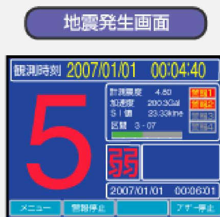
地震发生时的显示页面 时刻/实际震级/距离/加速度/深度/方位
