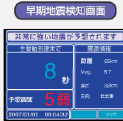
早期(前兆)地震检知时的显示页面 到达时间(倒计时)/预测震级/距离/加速度/深度/方位
