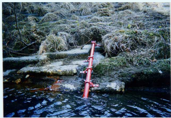
固定安装 (带空气校正导管电缆)
