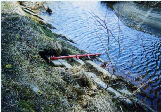
固定安装 (带空气校正导管电缆)
