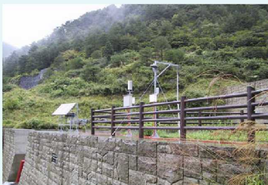
固定安装 (带空气校正导管电缆)
