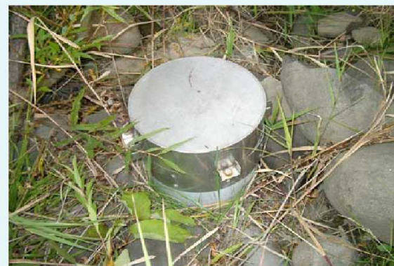
固定安装 (带空气校正导管电缆)
